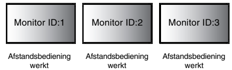
Illustratie 1 Afstandsbediening in normale modus of de REMOTE ID is ingesteld op 0
